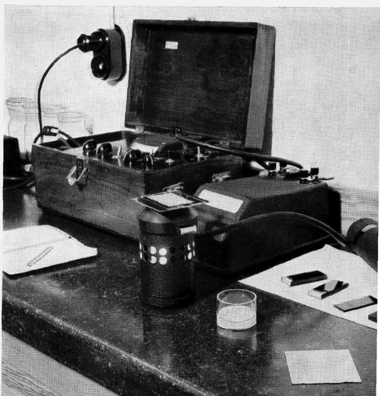
Reflectiemeter voor kleurmetingen aan maalprodukten
