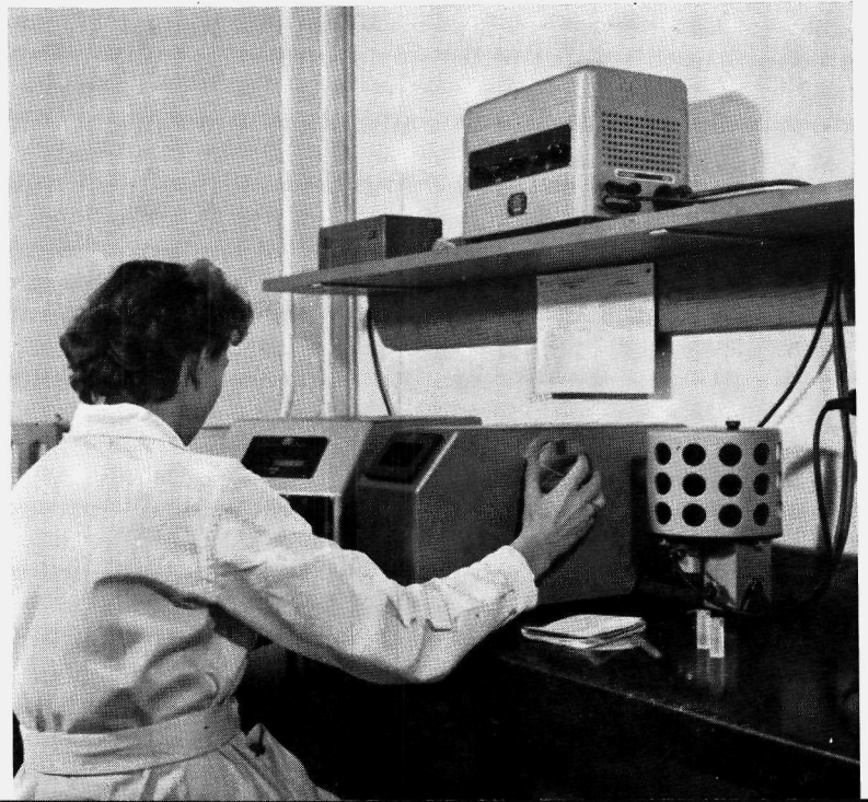
AFB. 6. Ultraviolet-spectrofotometer ter identificatie en kwantitatieve bepaling van o.m. bestanddelen van maal- en bakproducten
