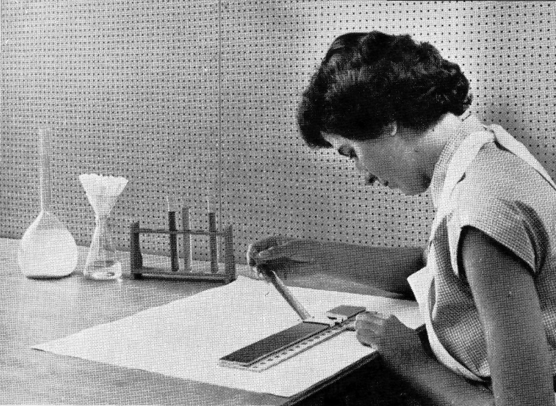
AFB. 3. Colorimetrische methode ter bepaling van de mate van schotaantasting in graanmonsters
