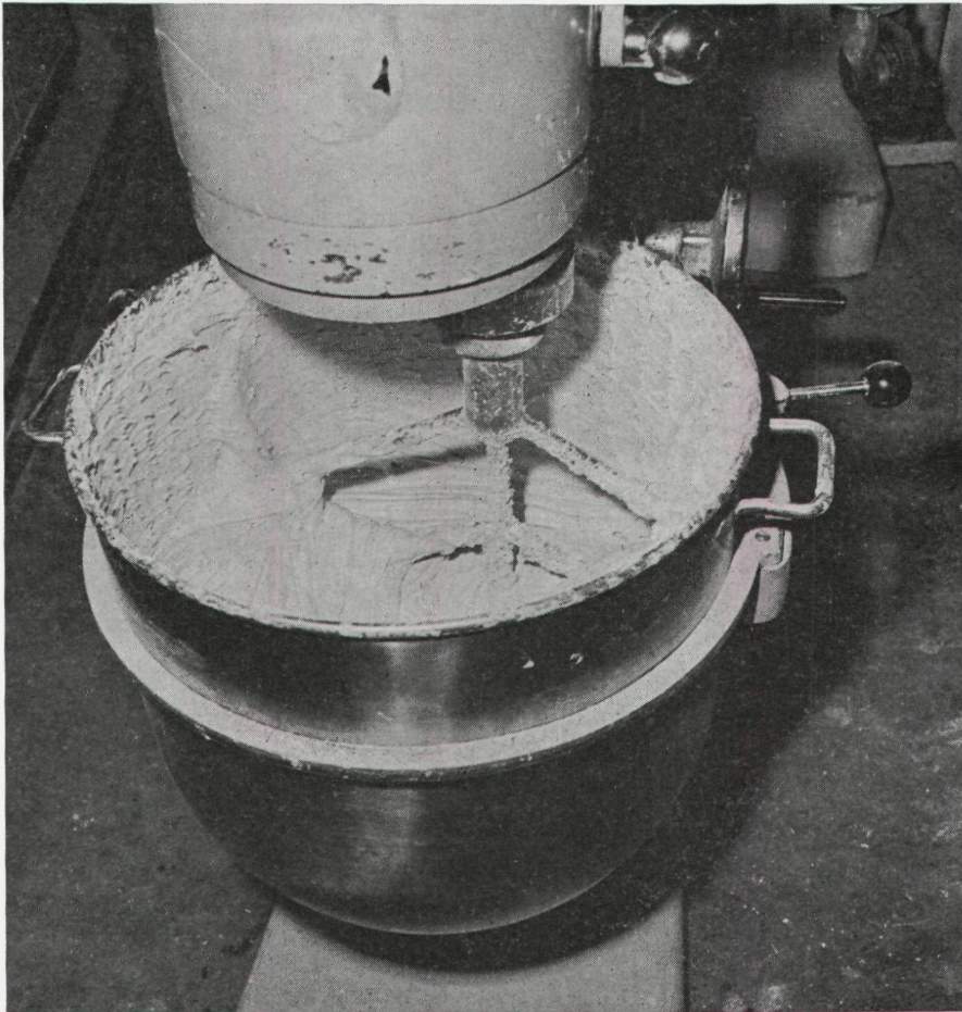
Mengkuip met 35 kg beslag voor cassave/sojabrood. Aan de uitsmering van het beslag langs de wanden is te zien dat het cassavedeeg weinig samenhang bezit (bij de bereiding van tarwedeg wordt de kuipwand, wanneer het deeg gereed is, vanzelf schoon doordat het deeg een samenhangend geheel gaat vormen).
