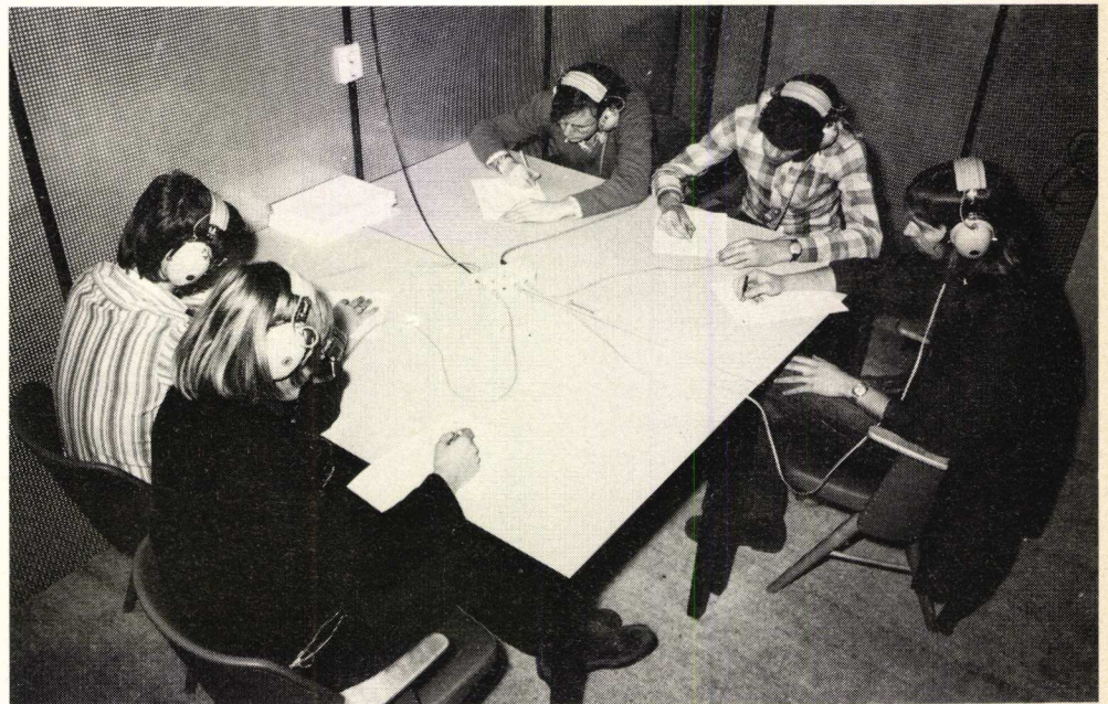
Fig. 2 Een groep luisteraars bezig met een klassieke verstaanbaarheidsmeting. Hiervoor worden speciale woordlijsten gebruikt, waarbij het percentage goed genoteerde woorden bepalend is voor de kwaliteit van het onderzochte transmissiekanaal.
