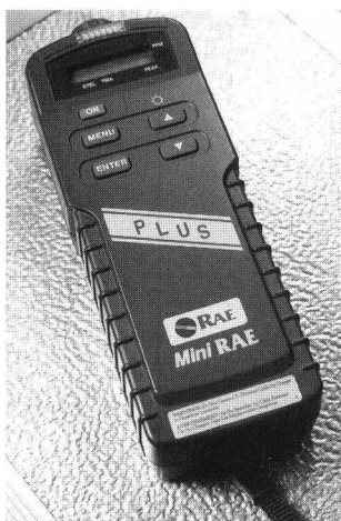
PID-METER GESCHIKT VOOR PERSOONLIJKE MONITORING FOTO MICHEL WIELICK
