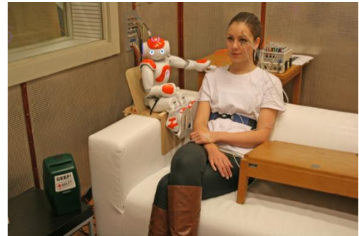
Figuur 5 Experimentele opstelling van de aanraking door een robot.
