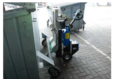
De one2move kan worden gekoppeld aan alle typen containers en wordt bediend door middel van een remote control. De chauffeur hoeft met de andere hand alleen de container bij te sturen.
