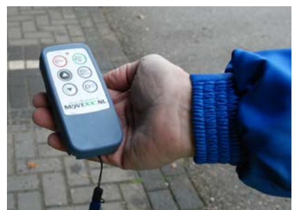
De one2move kan worden gekoppeld aan alle typen containers en wordt bediend door middel van een remote control. De chauffeur hoeft met de andere hand alleen de container bij te sturen.
