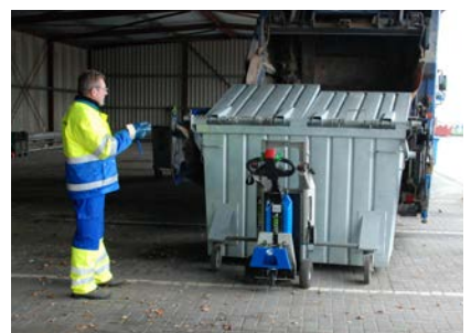
De one2move kan worden gekoppeld aan alle typen containers en wordt bediend door middel van een remote control. De chauffeur hoeft met de andere hand alleen de container bij te sturen.
