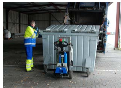
Nieuwe situatie: verplaatsen en positioneren van zware stalen container met behulp van one2move
