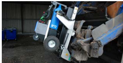
Na gebruik kan de one2move zichzelf vastmaken aan de achterkant van het inzamelvoertuig of in de speciaal ontworpen kantelkist aan de zijkant van de wagen.
