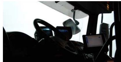
Diverse aanpassingen aan de wagen: extra camera's, extra beeldscherm en laadstation voor accu
