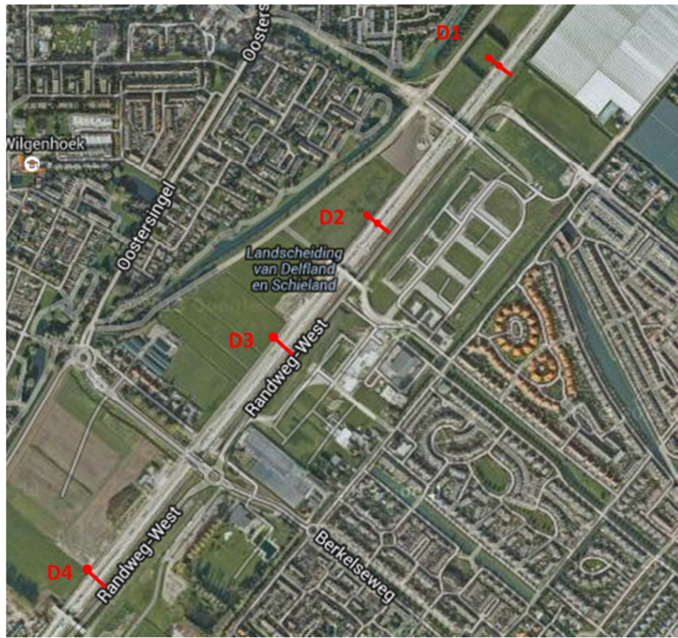
Figuur 2 Overzicht van de meetdoorsnedes: meetdoorsnede D1 op km 110.885, D2 op km 110.510, D3 op km 110.190 en D4 op km 109.591.
