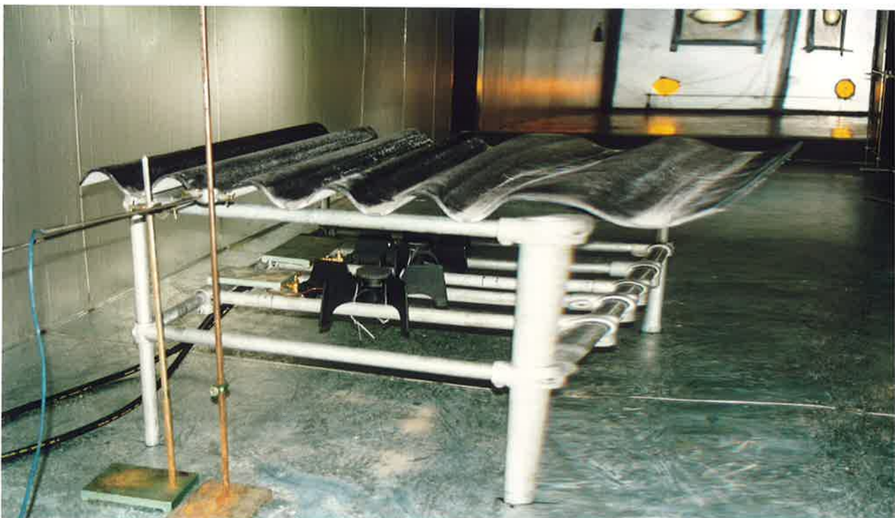
Figuur 10.4 “Sloepenrol” met een asbestvrije golfplaat en twee branders. De temperatuur boven- en onderzijde van de plaat wordt met thermokoppels gemeten. Later zal de branderopstelling nog diverse wijzigingen ondergaan.
