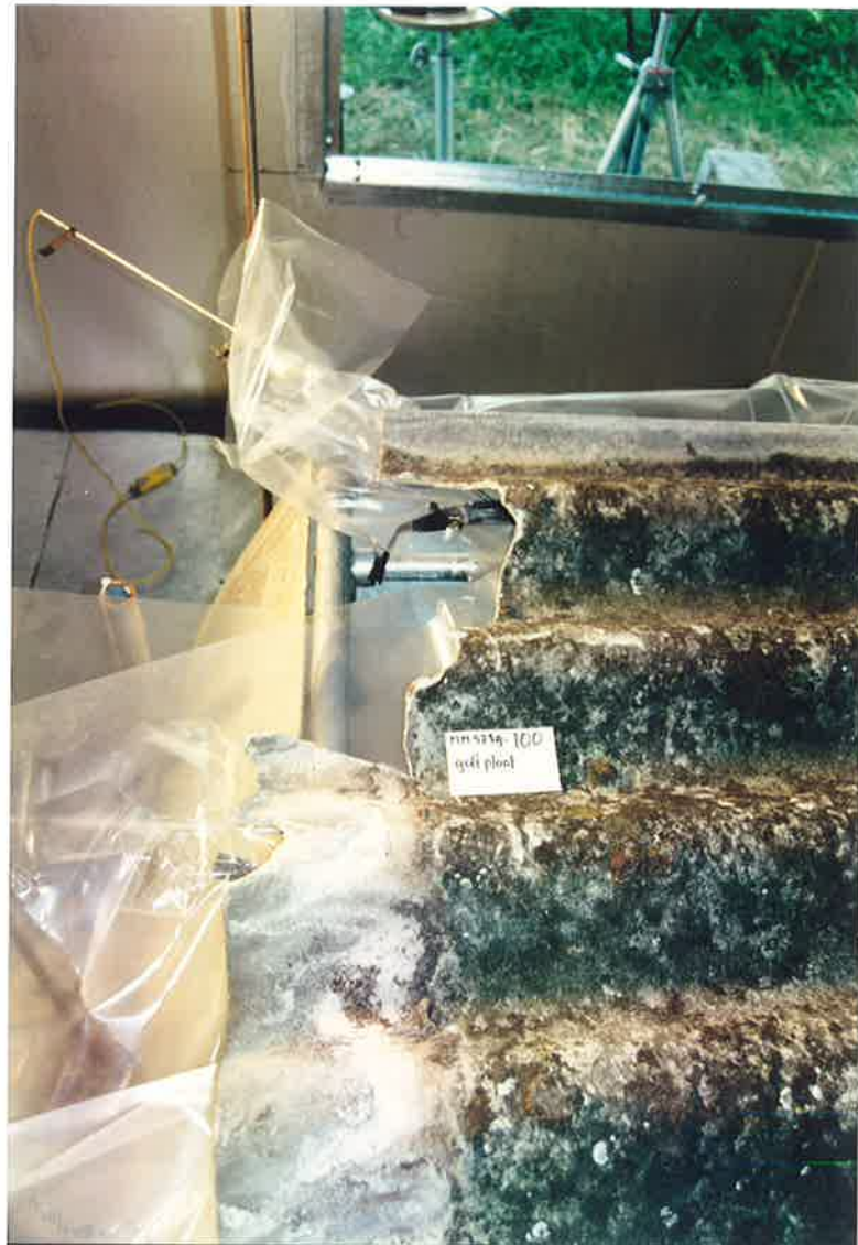
Figuur 10.5 De voor de proefnemingen gebruikte verweerde asbestcementgolflaat. Door het raam is op de achtergrond nog het statief van de camera-opstelling te zien.
