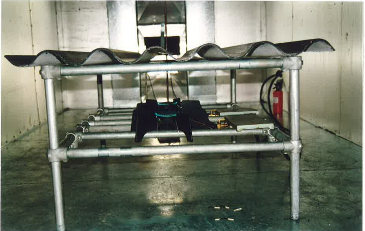
Figuur 10.1 De (eerste) testopstelling, gezien vanuit de voorzijde. Aan de achterzijde bevindt zich de toegangsdeur naar de sluisruimte. In de deur bevindt zich een opklapbare “flap” om de via de achterliggende ruimte ingeblazen lucht toe te laten.
