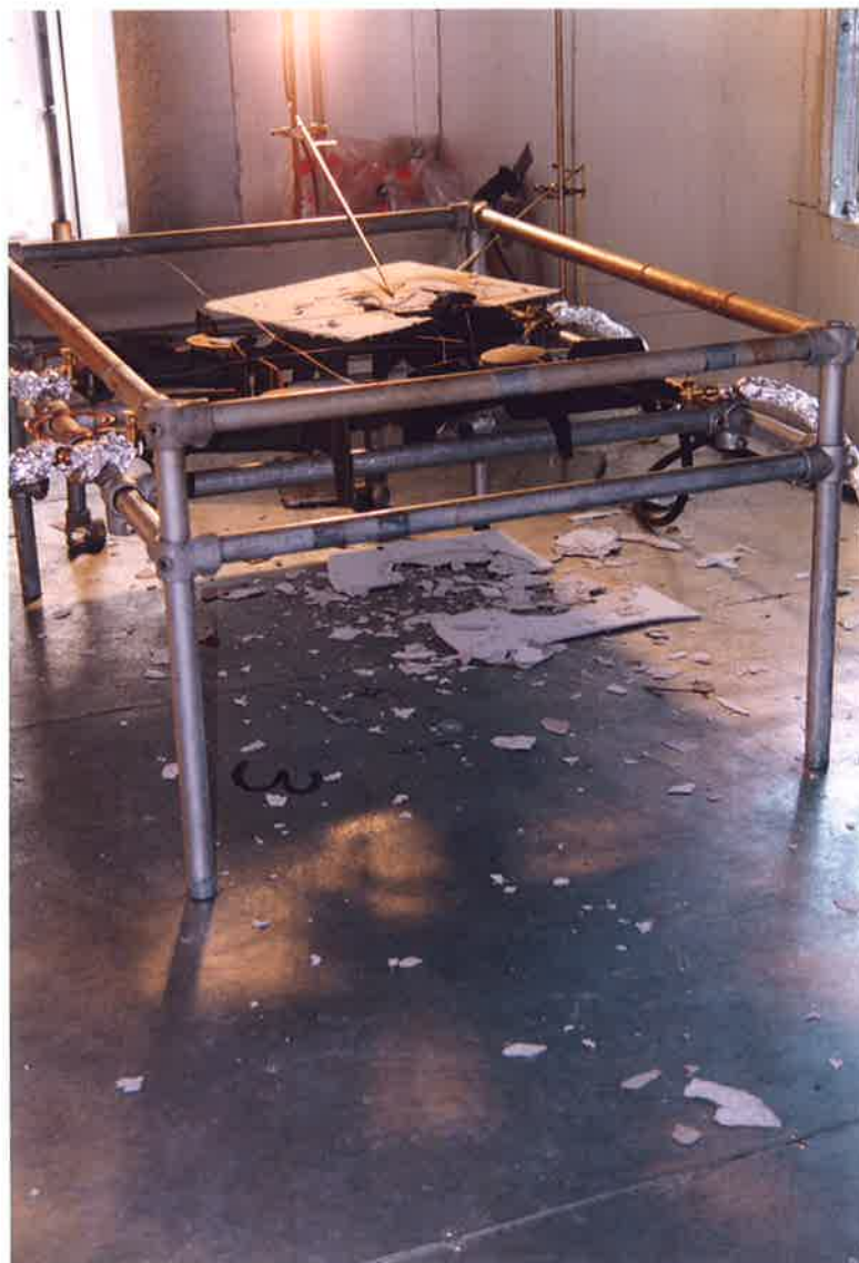
Figuur 10.13 De plaat is in flinters uiteengespat. Onder de brandertafel bevinden zich ook nog de resten van het eerste proefstuk.
