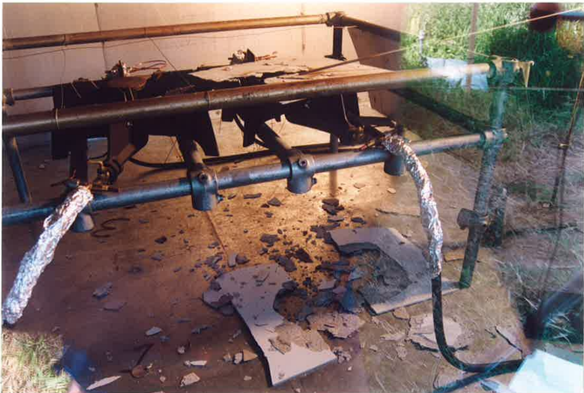
Figuur 10.16 Overzicht van de stukken en flinters die bij het exploderen van de 5 mm dikke Glasal-plaat zijn vrijgekomen.
