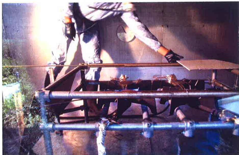
Figuur 10.9 Het aanbrengen van een proefstuk (Glascal-plaat) op de brandertafel.
