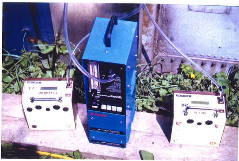
Figuur 10.7 Deel monsterpompen die buiten de container zijn opgesteld. De pompen zijn met slangen, die via gaten in het dak zijn doorgevoerd, verbonden met filterhouders waarmee de luchtmonsters simultaan worden genomen.
