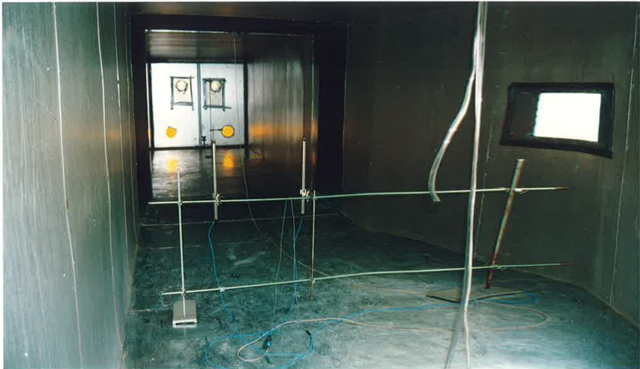
Figuur 10.3 Overzicht van de proefruimte. Aan het uiteinde (“voorzijde”) zijn de opening waardoor de lucht via de filterunits wordt afgevoerd. Alleen de twee bovenste gebruikt en de onderste zijn afgesloten. De op de statieven geplaatste buizen met hittedraad-anemometers waarmee de luchtsnelheden zijn gemeten.
