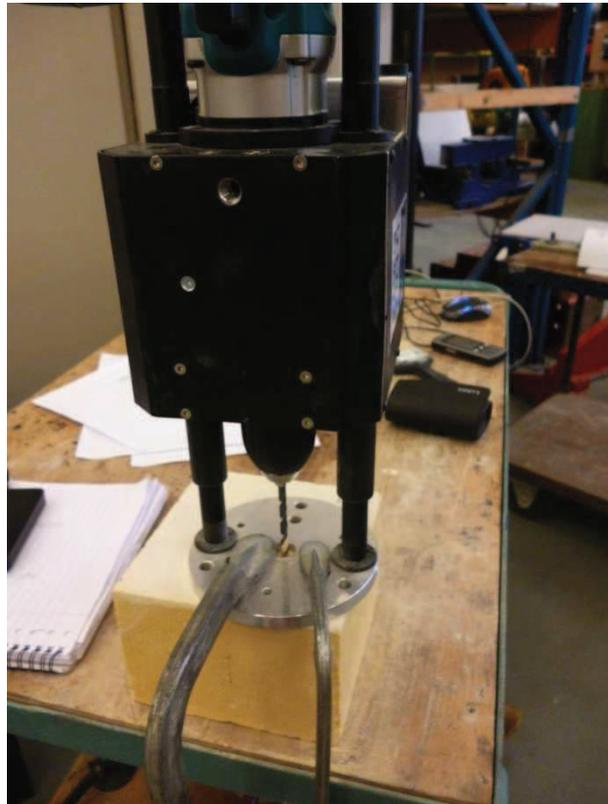
*Fig. 5. Bepaling van de indringingsdiepte door middel van boorweerstandsmetingen uitgevoerd in een laboratoriumopstelling.*
