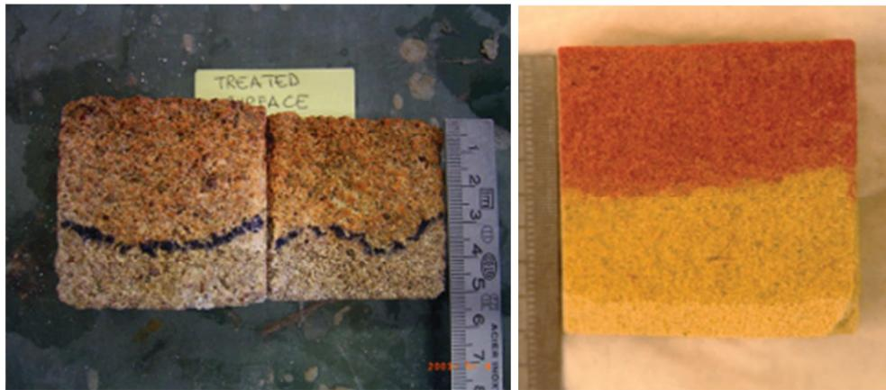
*Fig. 4. Gebruik van een indicatorvloeistof om de aanwezigheid van een product in een ondergrond vast te stellen (laboratoriumsituatie). Links dithizon, voor het vaststellen van de indringingsdiepte van ethylsilicaat; rechts phenolphthaleïne voor het vaststellen van wel en niet gecarbonateerde zones, na behandeling met een nanokalk.*
