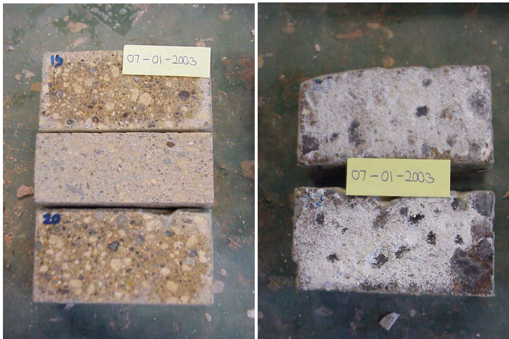
Fig. 10. Ettringer (links) en Römer (rechts) tuf tijdens zoutkristallisatietest met Na 2 SO 4 in het laboratorium na 4 weken (Brendle 2003).
