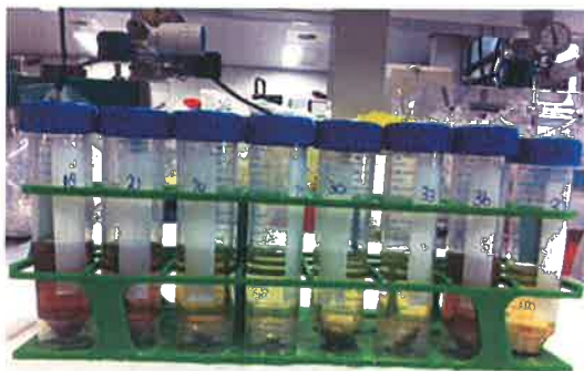
Foto 3: Extracten na 10 minuten afdraaien bij 1000xg
