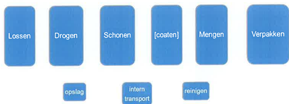
Figuur 23: Procesbeschrijving van een typisch verwerkingsproces voor landbouwzaden.
