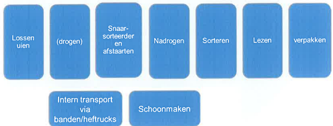
Figuur 12. Procesbeschrijving van een typisch verwerkingsproces voor uien
