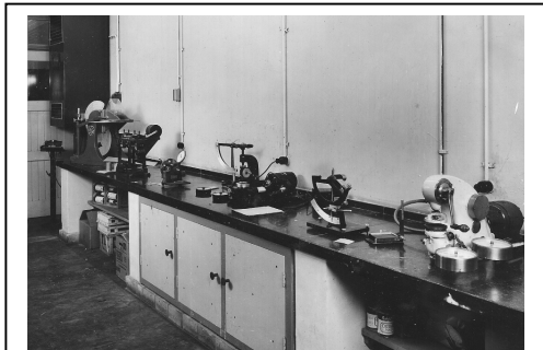
Het karton- en papierlaboratorium. Onder andere v.l.n.r. de doorsteekweerstandsmeter, balansje voor meting basismassa, scheurweerstandsmeter en berstdrukmeter
