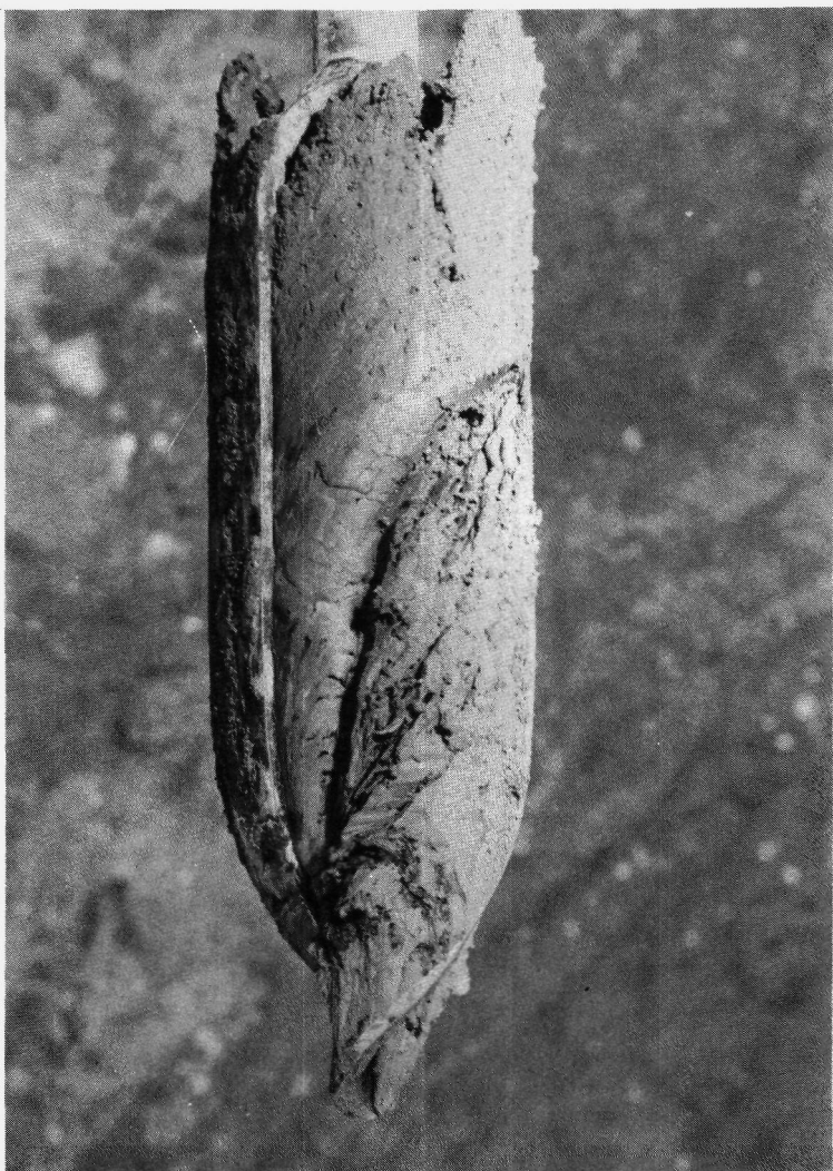
3.3 Een zogeheten Edelman-handboor, opgehaald en gevuld met een klei. De handboor is ontworpen voor bemonstering van de bodem ten behoeve van grondsoort-kartering; boor en boormethode zijn niet altijd geschikt voor bodemontsluiting en -bemonstering ten behoeve van milieuhygiënisch bodemkwaliteitsonderzoek.
