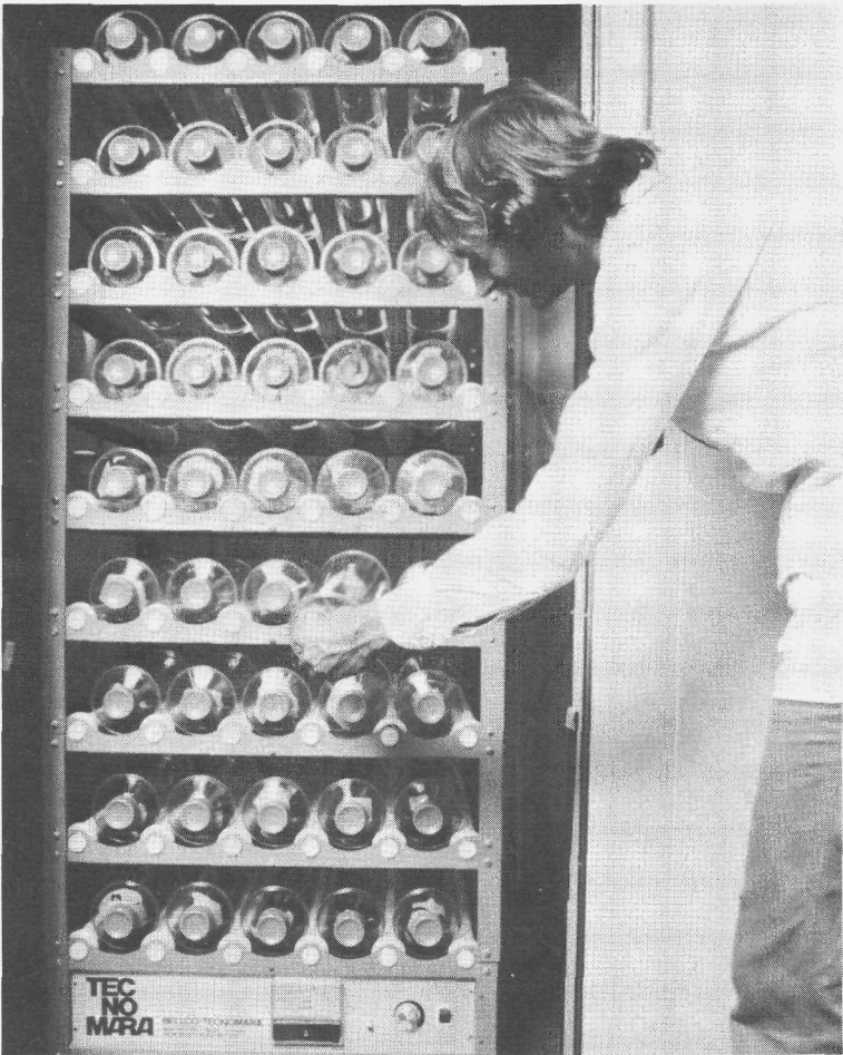
Fig. 11.5. Rollermachine. Ook voor de produktie van ratte-interferon in ons laboratorium bij TNO moeten de cellen aan een onderlaag vastzitten om interferon te kunnen maken. Om grote oppervlakken te kunnen kweken maken wij gebruik van rollerflessen van de firma Falcon. Flessen die langzaam ronddraaien, zodat de cellen aan de hele binnenkant van de fles kunnen groeien. Een rollerfles geeft dan de oppervlakte van 10 standaard platte flessen. In deze machine kunnen we 100 rollerflessen tegelijk kweken met een totale oppervlakte van 8 m 2 . Ondanks deze schaal van celkweken kunnen we maar interferon maken voor 10 tot 20 experimenten per week. Deze produktie van ratte-interferon is zeer kostbaar en kunnen we ons alleen veroorloven dank zij subsidies van het Koningin Wilhelmina Fonds en het Praeventiefonds.
