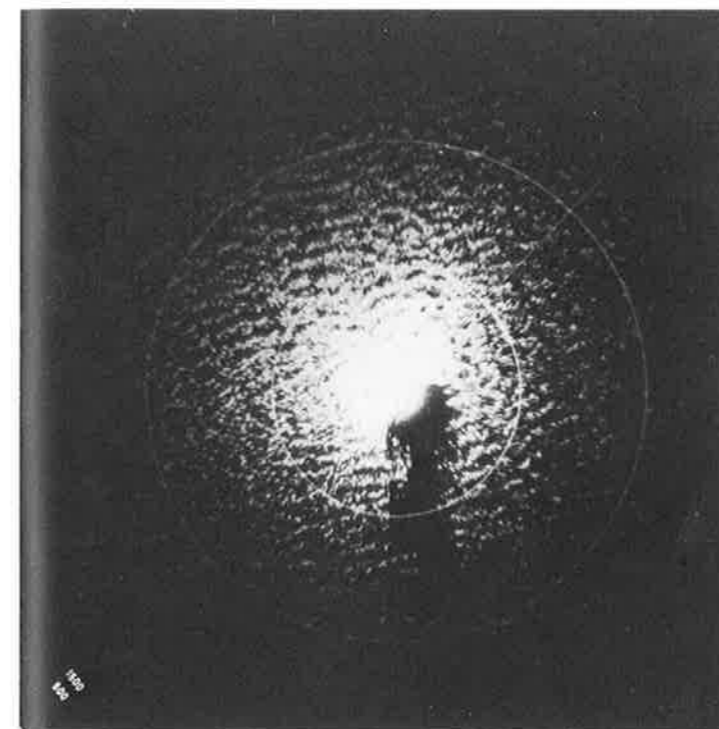
Figuur 10. Golfpatroon waargenomen door de 35 GHz scheepsradar op meetplatform Noordwijk; 24 okt. 1978; windsnelheid v = 15 m/s
