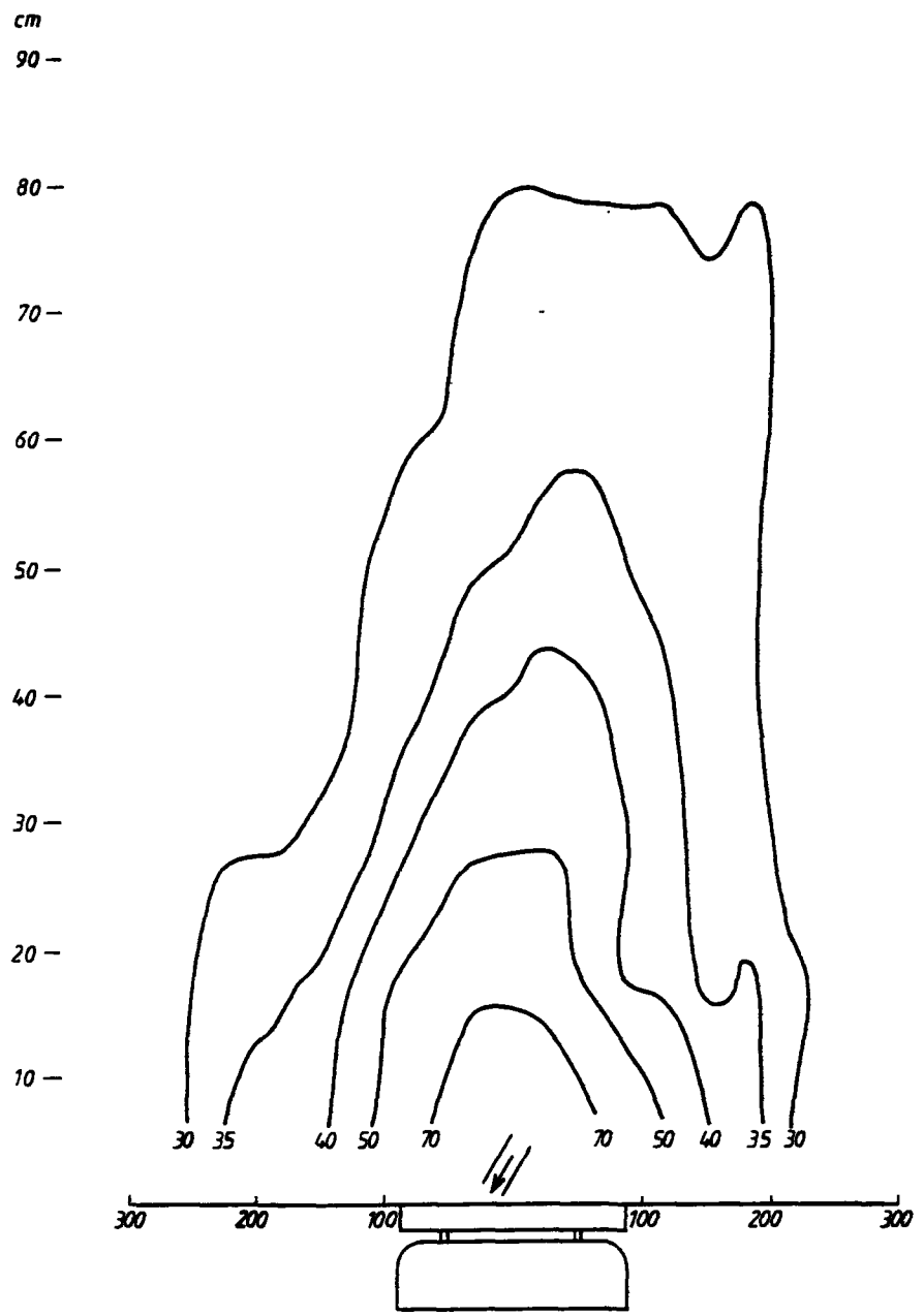
Temperaturen in °C bij proef 9: grote kookplaat 160 V met aanblaas 0,17 dm 3 /s onder 60° op het hart.
