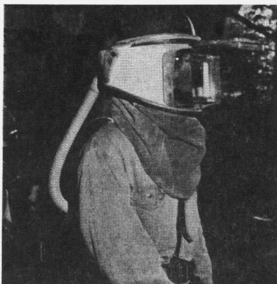
Fig. 10 Overdrukcap met afdichtingsflap. De luchttoevoer is via een oliescheider op de perslucht. aangesloten.
