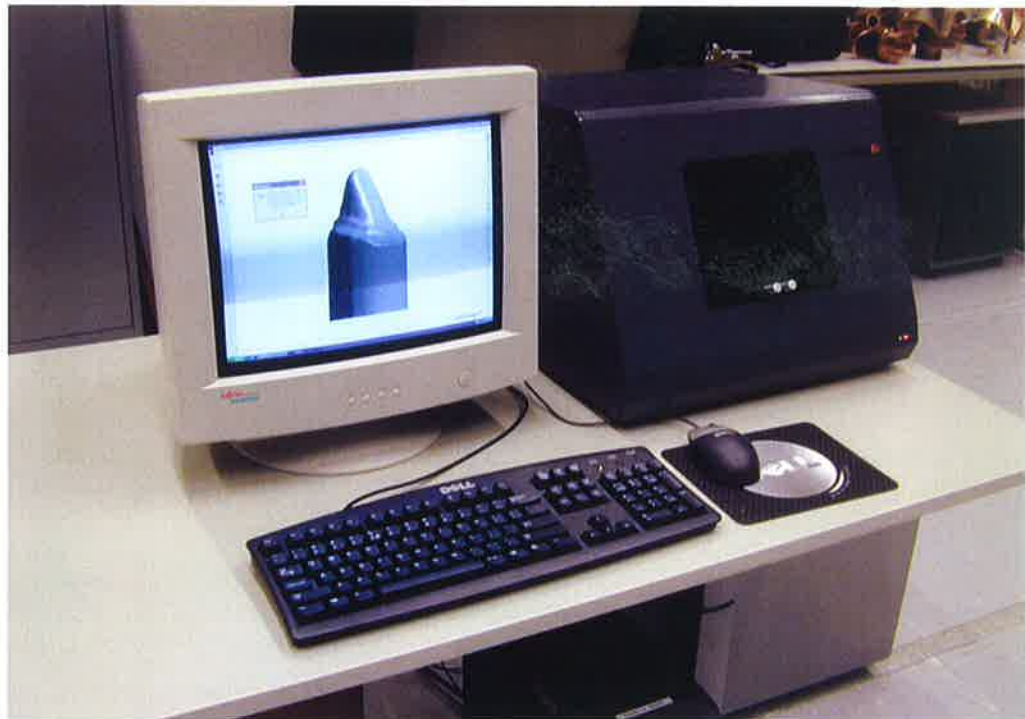
Stap 1: Tandtechnische laboratoria scannen de tandstomp.
