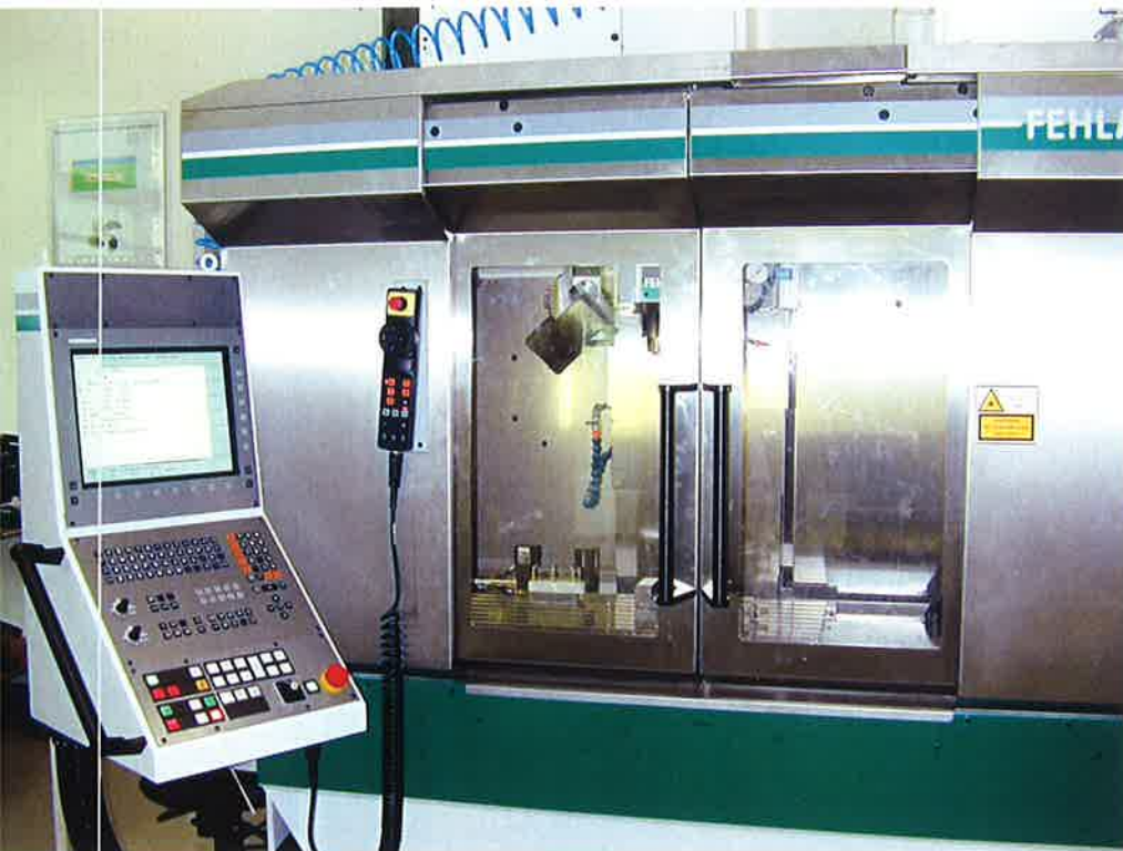
Stap 4: De freesmachine freest gelijktijdig een aantal producten uit een plak keramiek met een nauwkeurigheid van 0,015mm.
