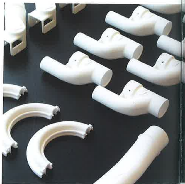
Met Selective Laser Sintering (SLS) en Fused Deposition Modeling (FDM) zijn functionele onderdelen gemaakt voor diverse handgereedschappen met stofafzuiging.
