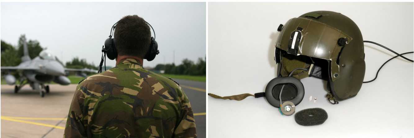
Figuur 4: Geluidsomgeving F-16 crewchief en geïntegreerde gehoorbescherming.
