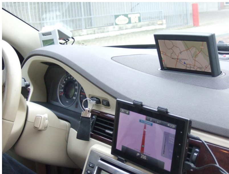
Figuur 24: OBU en tablet in voertuig.
