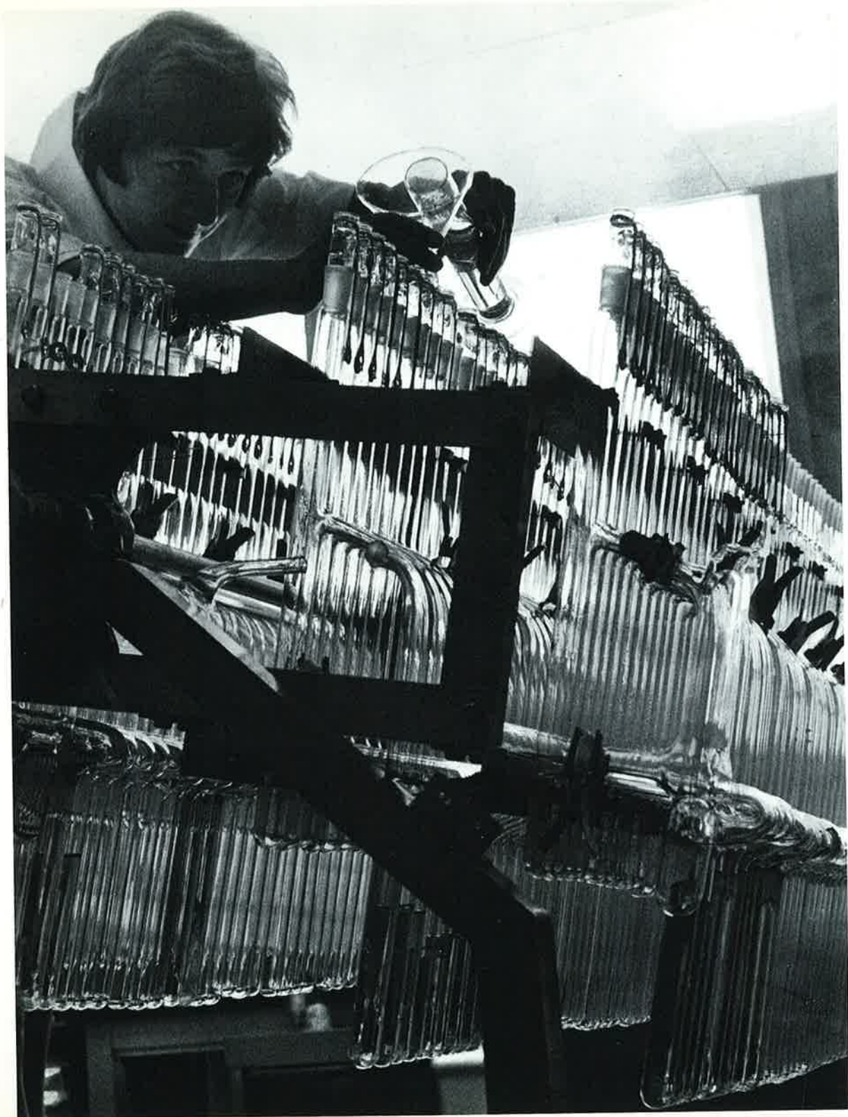
Dit orgel van glas heet officieel: 'Counter Current Distribution' apparaat. Het wordt gebruikt voor het scheiden van oplossingen in hun componenten.
