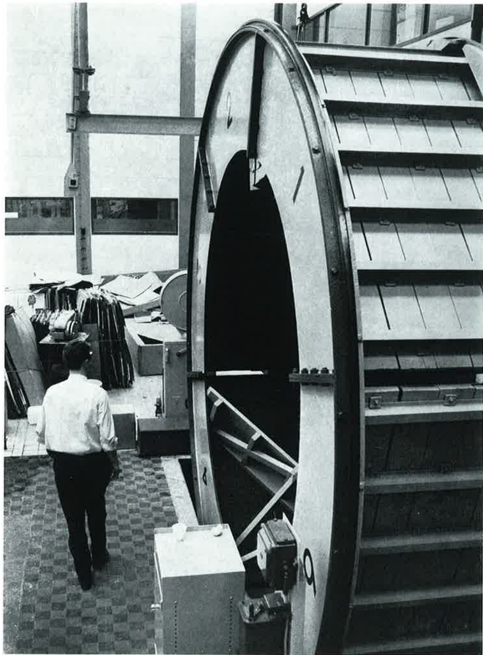
Roterende valtrommel voor het onderzoek van transportverpakking.
