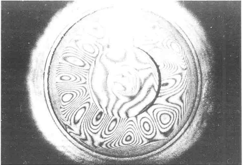
Fig. 2 Trillingspatroon van een luidsprekerconus, opgenomen met een dubbelpuls robijnlaser.
