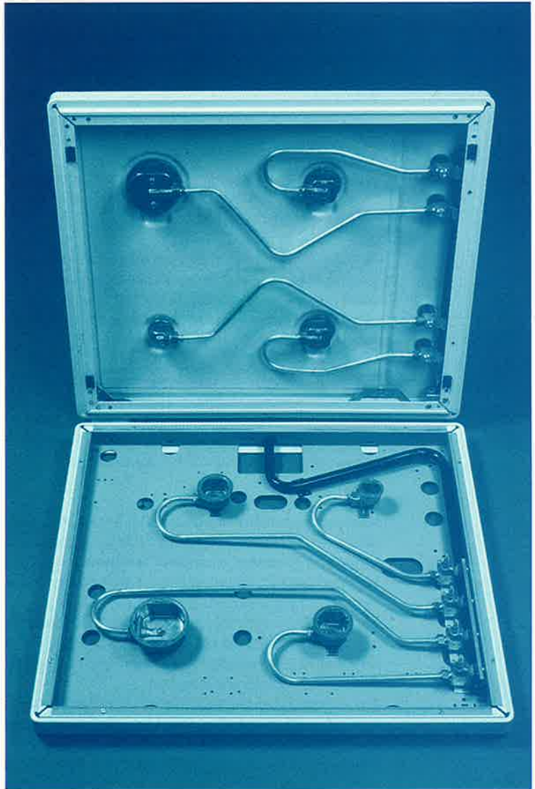
Buizenlay-out, referentieproduct (onder) en resultaat (boven)
