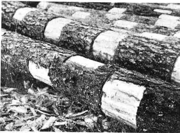
Fig. 6. Proef met stammen, welke vóór het vloten plaatselijk zijn ontbast. Deze methode volgens Björkman bevordert het drogen, terwijl tegelijkertijd het vormen van barsten wordt voorkomen, door de overblijvende, ononderbroken band van de bast, om de gehele stam.
