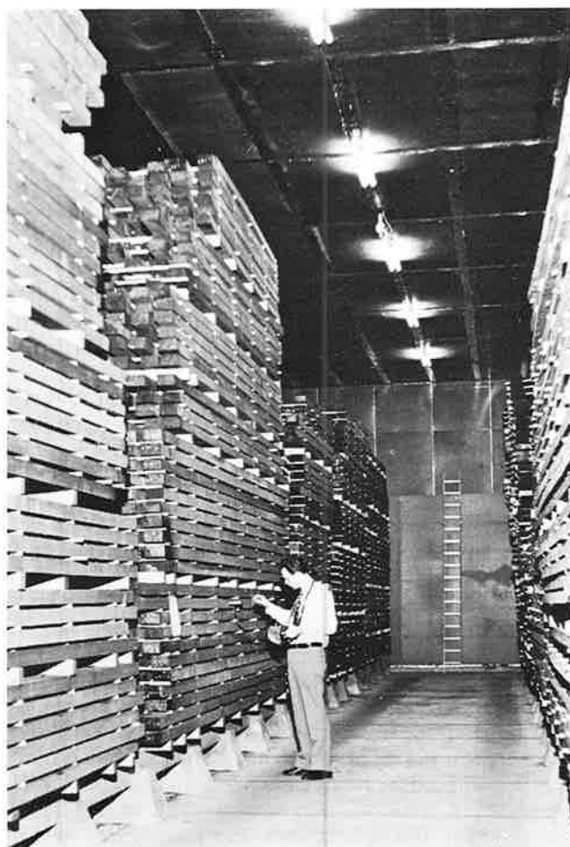
Fig. 60: Het drogen van 75 mm d donkerrode meranti in een geklimatiseerde droogruimte. Rijpad de ruimte voor het houttransport met zijladers. Op de achtergrond het convectorschot.
