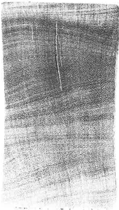
Fig. 34: Sterke collaps in imbuia, waarbij een klein inwendig scheurtje is ontstaan.
