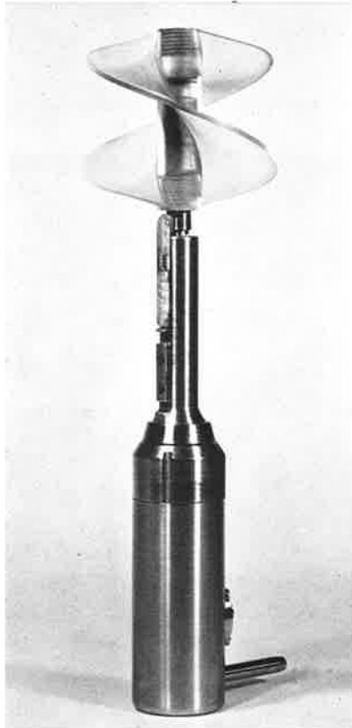
Door de Technisch-Physische Dienst TNO en TH geconstrueerde watersnelheidsmeter.
