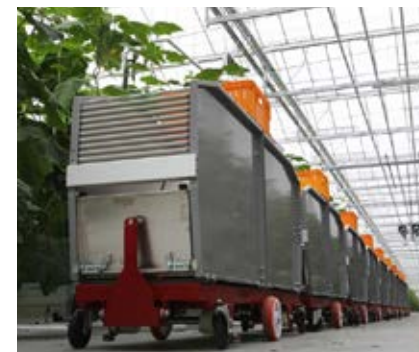
De aan elkaar gekoppelde containers met de extra kist er boven op
