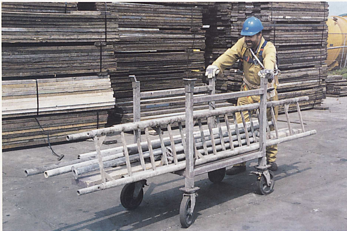
Figuur 1. Een transportkar, waardoor horizontaal transport niet meer handmatig hoeft plaats te vinden (zie figuur 3).
