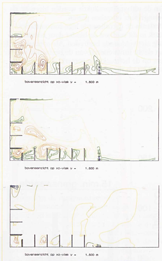
Figuur 2 Enkele karakteristieke concentratiepatronen van uitlaatgassen berekend met een simulatiemodel. Concentratiecontouren in de oude situatie (boven), de situatie met verhoogde ventilatie (midden) en de situatie met mengventilatoren (onder)
