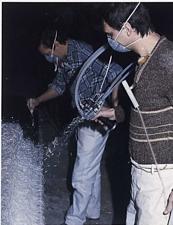
Figuur 2. De lamineertechniek, een situatie waarin medewerkers in contact komen met styreen
