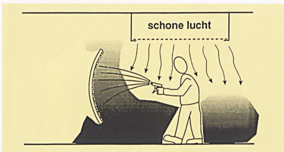
Figuur 4. Een lichtdouche zorgt voor een schone luchtzône rond de medewerker
