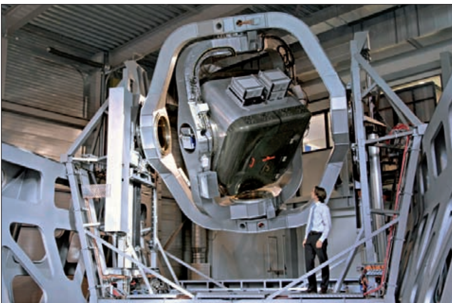
Afb. 2: De Desdemona simulator, die bij TNO in Soesterberg wordt gebruikt, is een vlieg- en rijnsimulator, desoriëntatietrainer en geavanceerd onderzoeksplatform in één. Deze wereldwijd unieke simulator kan worden gebruikt voor onderzoek én voor het nabootsen van complexe situaties waarin gevlogen, gereden of zelfs gevaar wordt.
