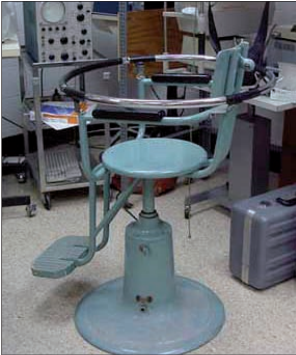
Afb. 4: De Bárány chair. De stoel wordt gebruikt om bewegingsziekte op te wekken d.m.v. de Coriolis stimulus.
