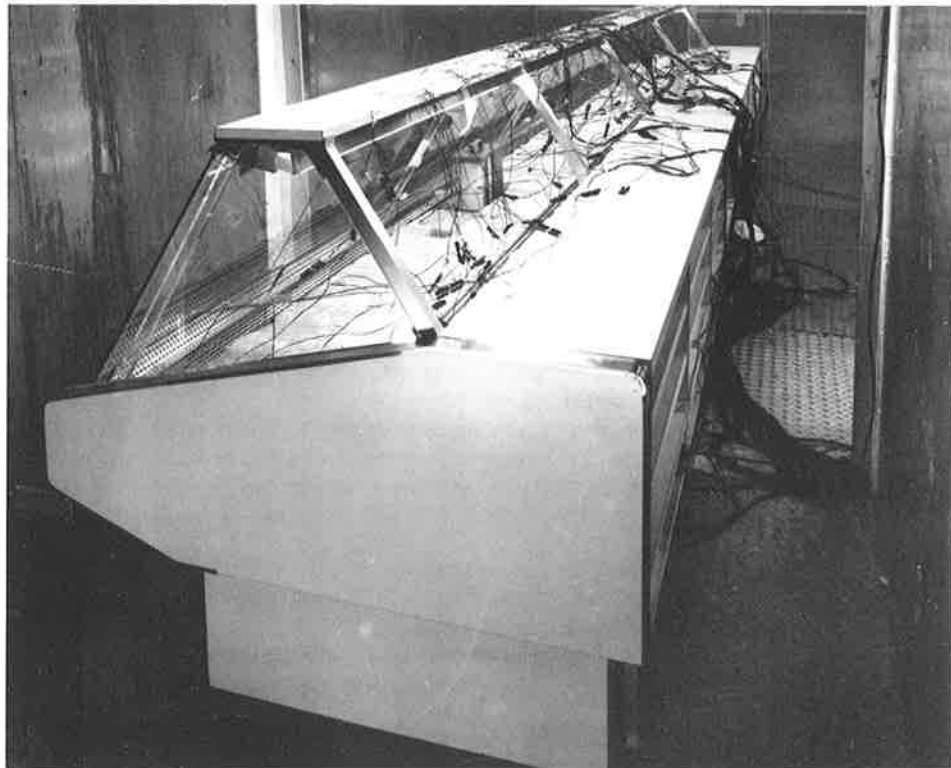
Beproeving van een koelmeubel in een klimaatcel.
