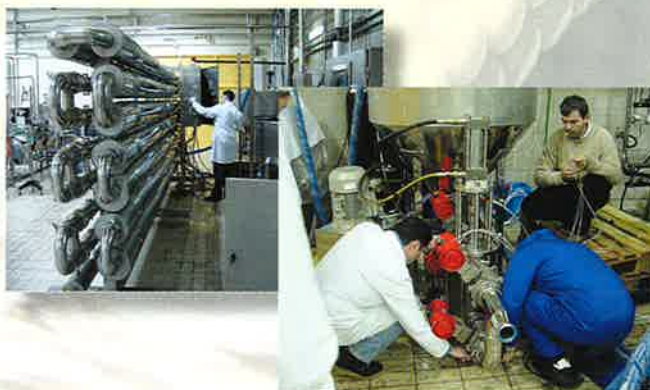
Proefinstallatie en buizenwarmtewisselaar op basis van TNO-patent.
