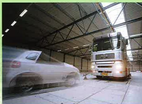
Moving Base nadert de Carlab truck in een VEHIL simulatie.
