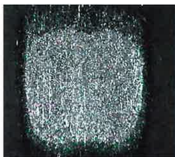
Oppervlak Niram-coating op aluminium na slijtagebeproeving met smeltslak.
