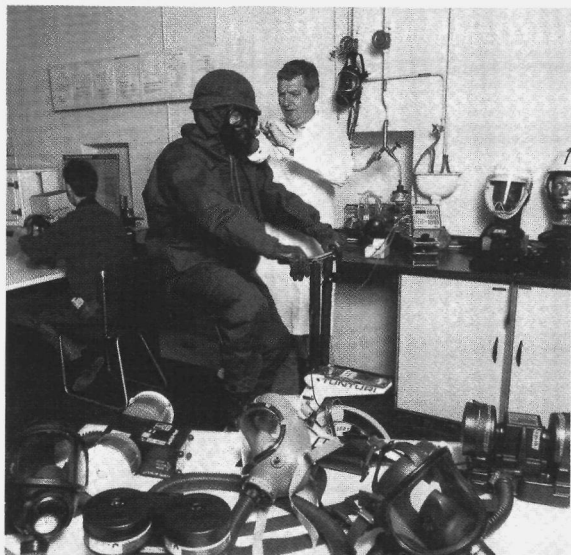
Onderzoek bij TNO-PML aan NBC-beschermende uitrusting met een proefpersoon op een hometrainer.
