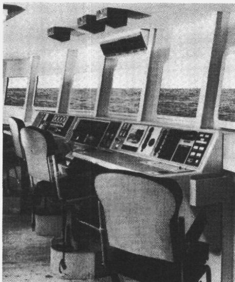
Deel van de brug van de Geleide Wapenfregatten met directe bediening van roer en schroeven.
