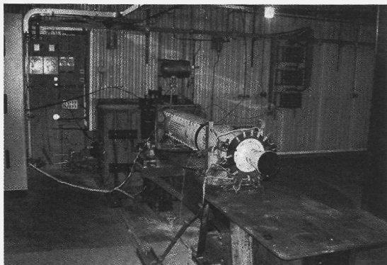
Het Standard Missile van de Koninklijke Marine klaar voor beproeving in de raketproefstand van TNO-PML.
