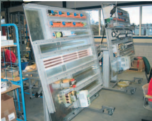
Het hef- en kantelhulpmiddel zorgt voor een ergonomisch verantwoorde assemblage-werkplek.
