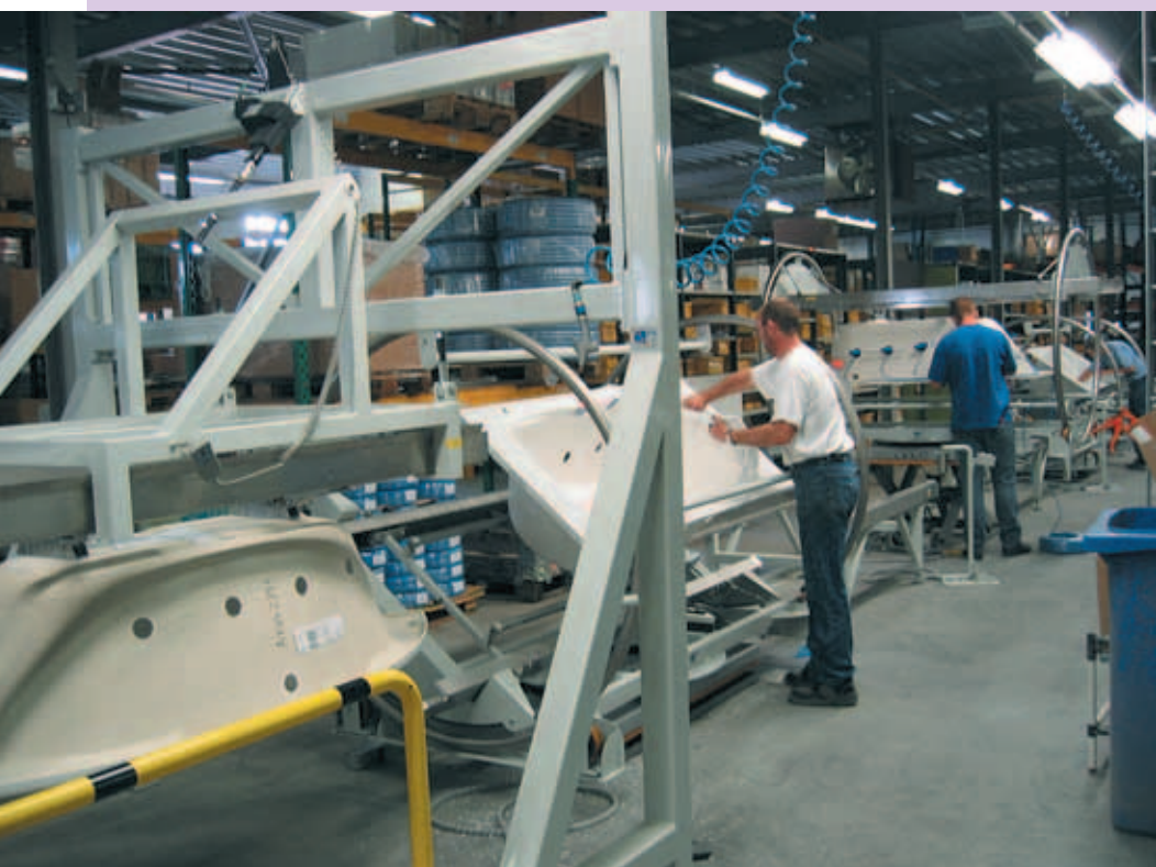
De nieuwe lijn: met de hoepelinstallatie op de hefinstallatie kan een badkuip eenvoudig worden gekanteld.
