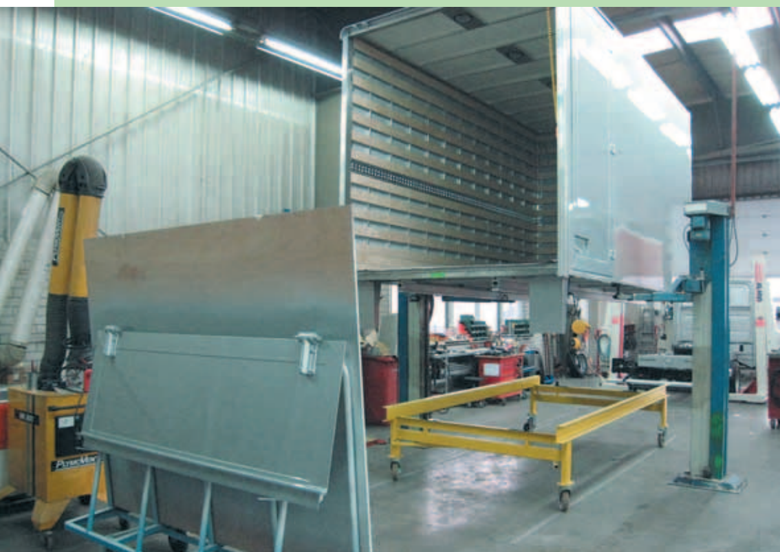
De box is klaar om op het chassis te worden geplaatst.
