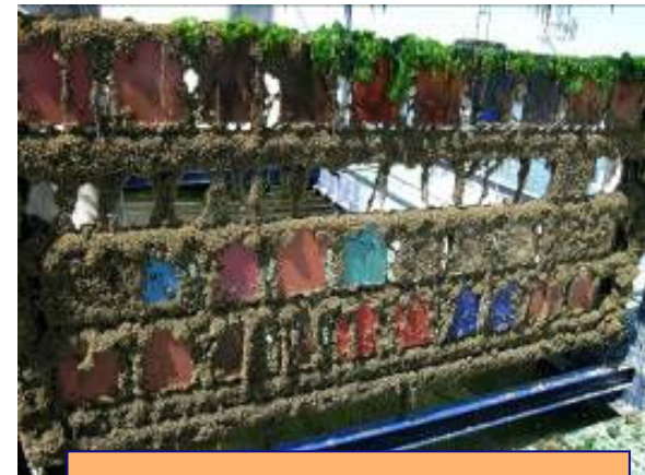
Antifouling coatings op TNO proefvlot in haven van Den Helder
