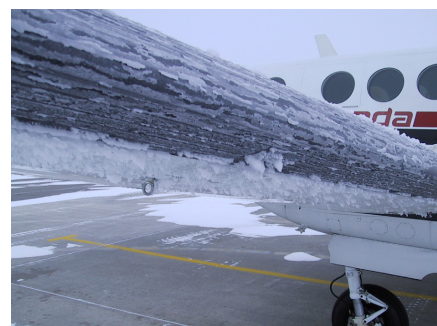
Wing ice, wellicht te voorkomen door moderne coatings.
