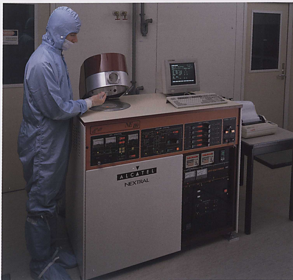
Figuur 4.5 De Reactieve Ionen Etser in de Stofarme Ruimte. Een substraat wordt in de etskamer geplaatst. Dit apparaat kan volledig automatisch een serie etsstappen uitvoeren.
