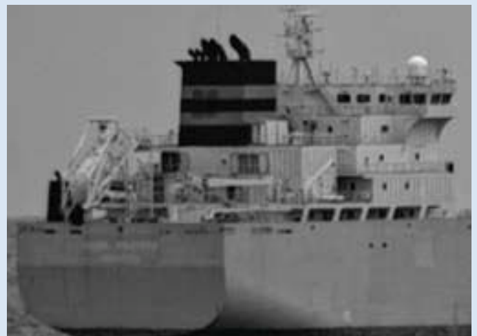
De toegepaste correctie op de turbulentie maakt het mogelijk om schepen op veel grotere afstand te herkennen.
