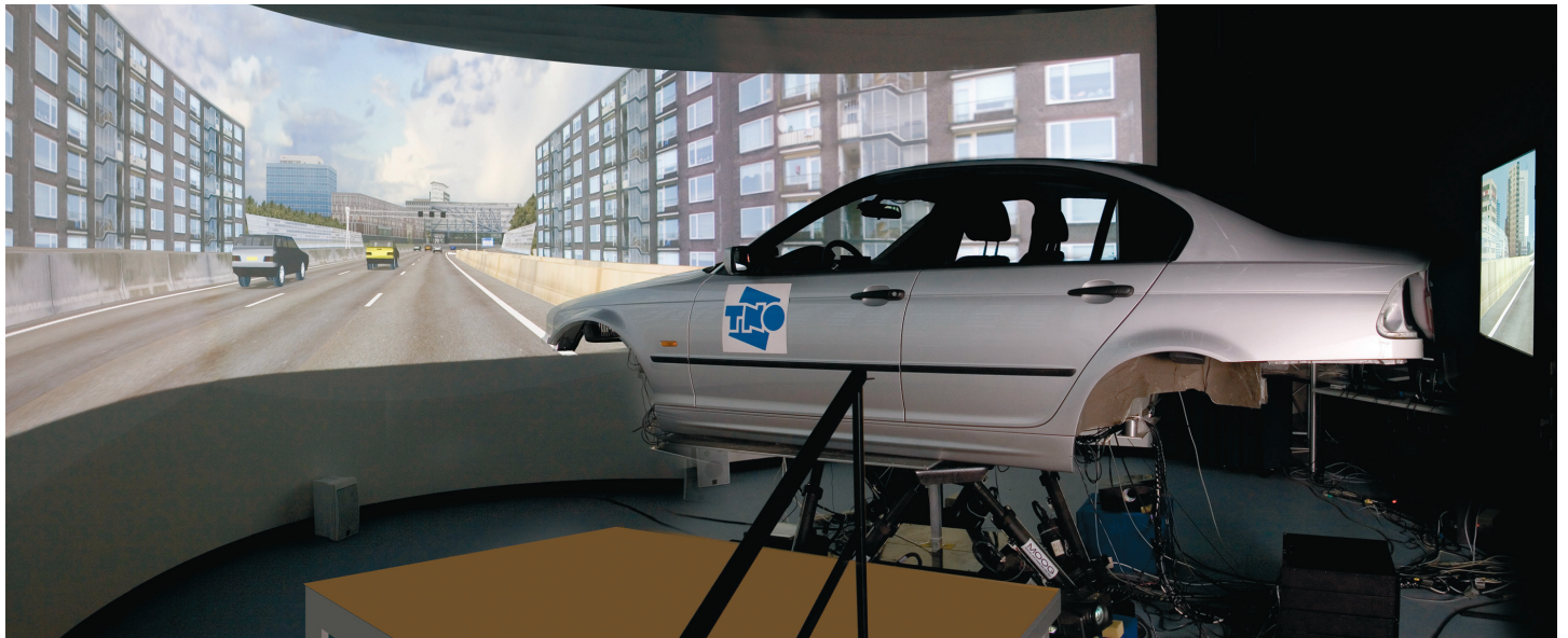
Figuur 2: De rijimulatoropstelling zoals gebruikt bij het testen van de File-assistent en bij onderzoek naar gedrag van bestuurders op kruispunten
