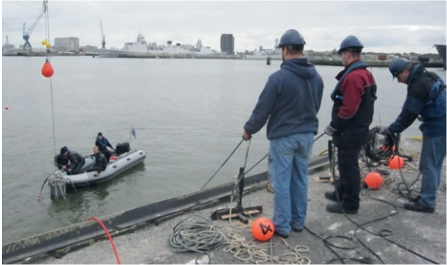
Figuur 6 Experimenten met passieve sonar voor de onderwaterdetectie van indringers in de havens van Den Helder.
