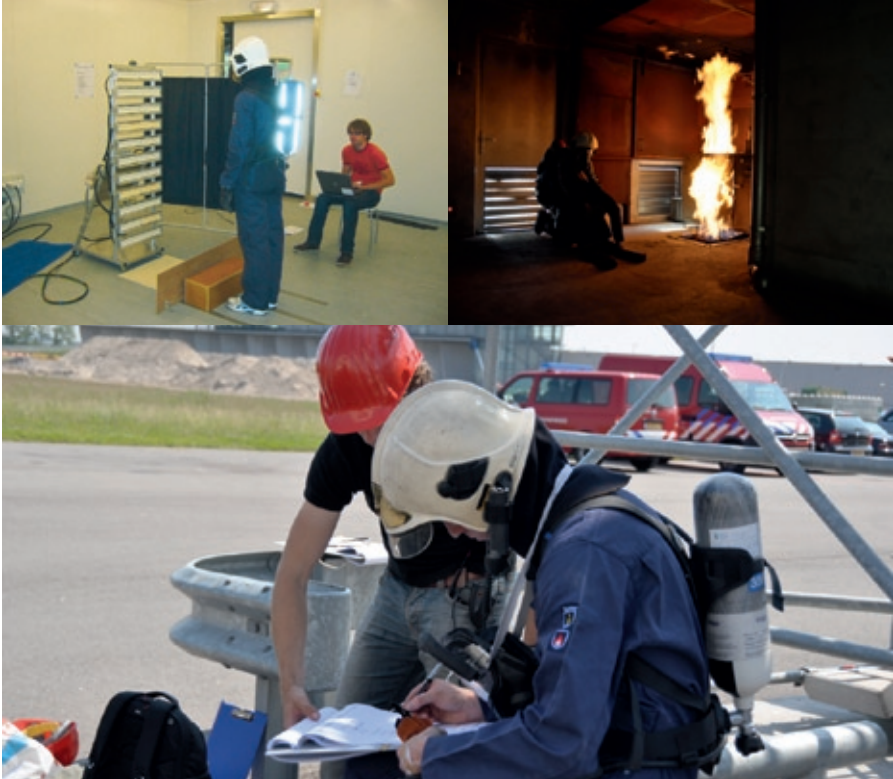
Figuur 17 De experimenten met lichtgewichtuitrusting in het TNO fieldlab bij BOCAS in Amsterdam toonden aan dat maximale bescherming niet voor alle incidentscenario's optimaal is. Vernieuwing naar modulaire, taakspecifieke uitrustingsconcepten is wenselijk.
