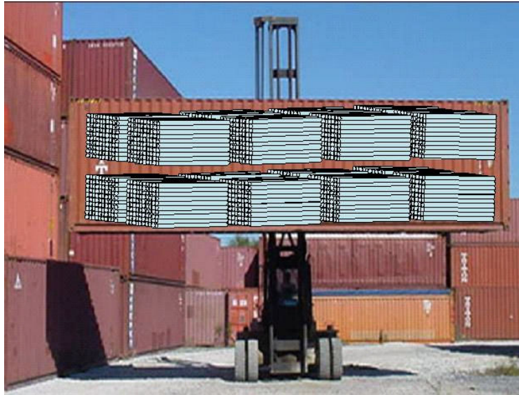
Figuur 12 16 HotCO2 modules in een container
