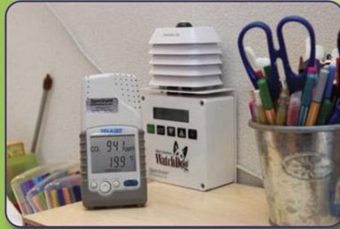
De Watchdog, meetapparaat voor CO 2 , RV en temperatuur.
