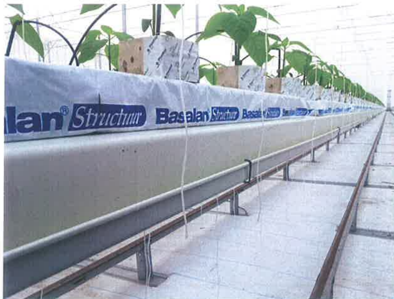
Figuur 39: Foto van de gecoate goot (eind november 2012, 2 weken na start; de groenige kleur komt voort uit de camera, dit betreft geen aanslag maar reflecties van planten)
