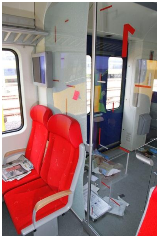
Figuur 15 Toepassing van type C gelaagd glas, bij breuk desintegreert het glas in kleine deeltjes.
