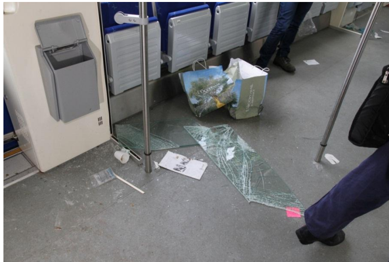
Figuur 17 Type B glas dat is uiteengevallen in verschillende delen met messcherpe punten.
