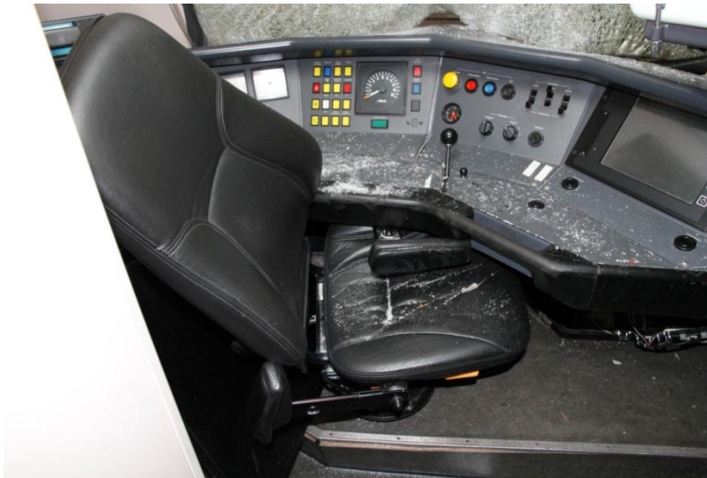
Figuur 5 De beschikbare ruimte, na botsing, opgemerkt moet worden dat de stoel circa 90 graden met de klok mee is gedraaid.
