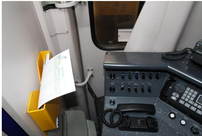
Figuur 3 De cabine waarbij het dashboard naar achteren geschoven is.
