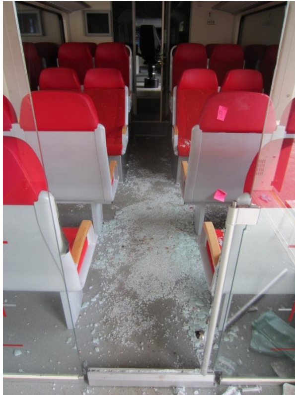
Figuur 16 Een voorbeeld van de toepassing van type C glas, de deur is na de botsing gebroken in oneindig kleine stukjes relatief ongevaarlijk glas.
