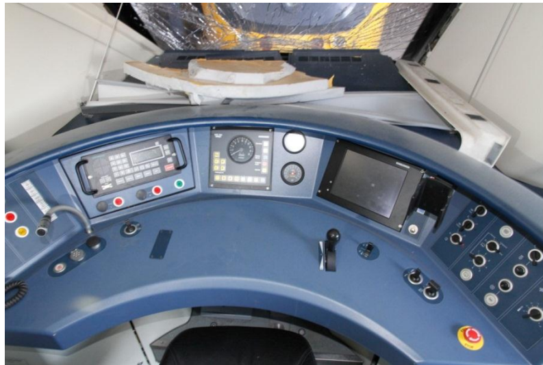
Figuur 9 De cabine na botsing.
