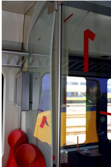
Figuur 11 Een informatiepaneel geplaatst binnen het bewegingsgebied van het hoofd.
