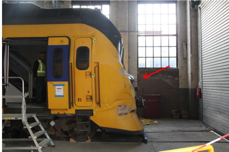
Figuur 1 De VIRM na botsing.
