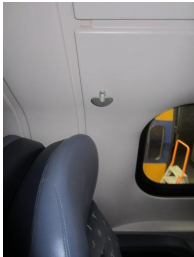
Figuur 12 De kledinghaak zit gevaarlijk dicht in de buurt van het hoofd van passagiers.
