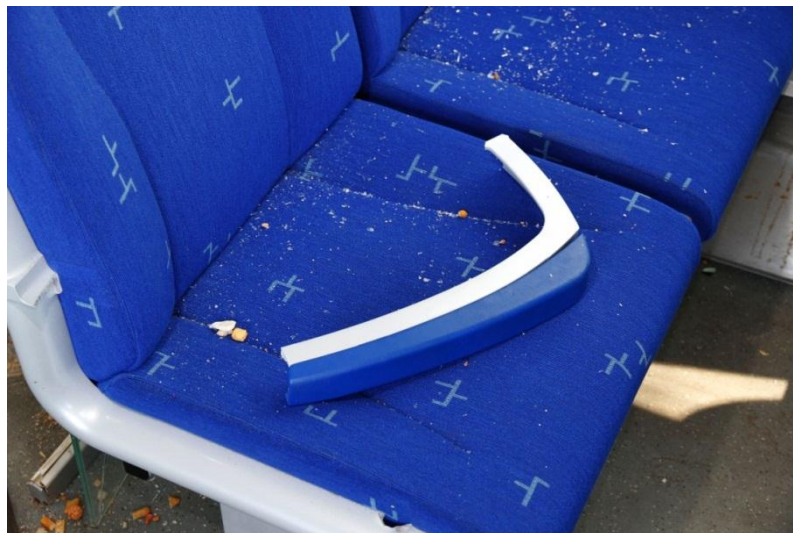
Figuur 18 Op de zitting van deze stoel lagen, onder meer, vele kleine scherpe glasdeeltjes ten gevolge van spalwerking.
