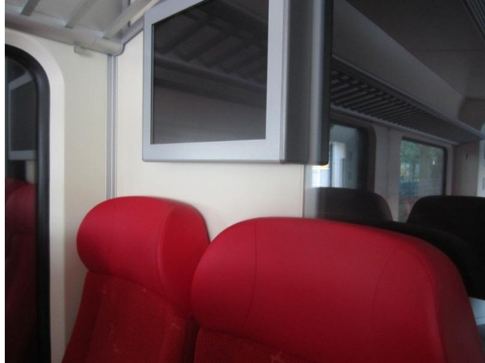
Figuur 19 Een infopaneel dat is geplaatst binnen het gebied waarbinnen het hoofd van een passagier zich kan bewegen.
