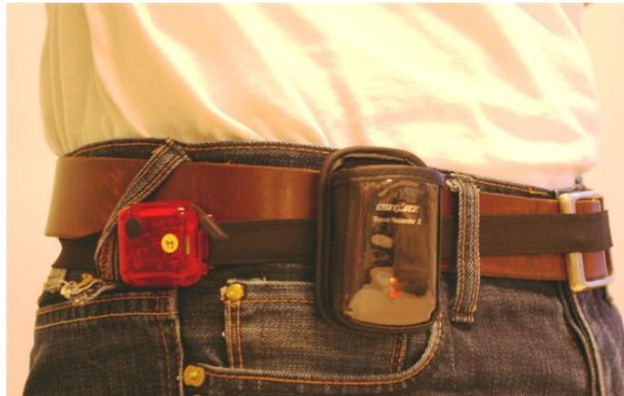
Foto 2.1 Dragen van ActiGraph versnellingsmeter en Travel Recorder X GPS-meter.
