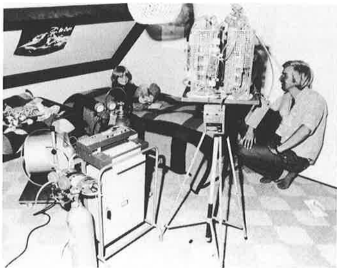
Afbeelding 2: De meting van de formaldehydeconcentratie in een zolderkamer. (foto IMGNTNO)
