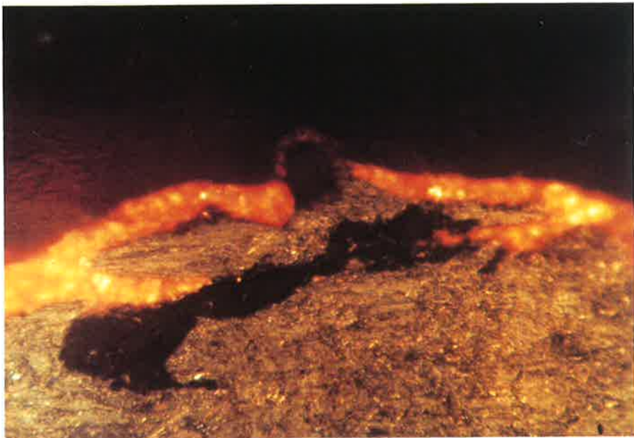
Foto 9: Roestvorming op insluitel van gietijzergrit
