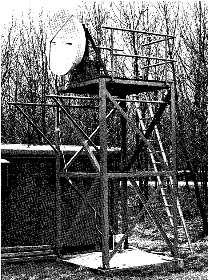
Meetopstelling 94 GHz te Ypenburg
