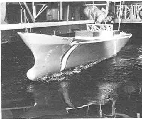
Model van een schip in het zeegangslaboratorium van het NSP.
